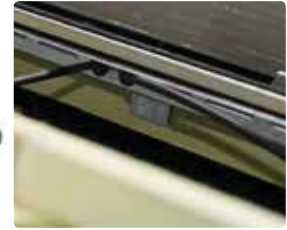
46 Aan de ophangnokken van de modules bevinden zich voorzieningen voor het aansluiten van aardingsleidingen. Gebruik deze voorzieningen als aarding noodzakelijk is.
